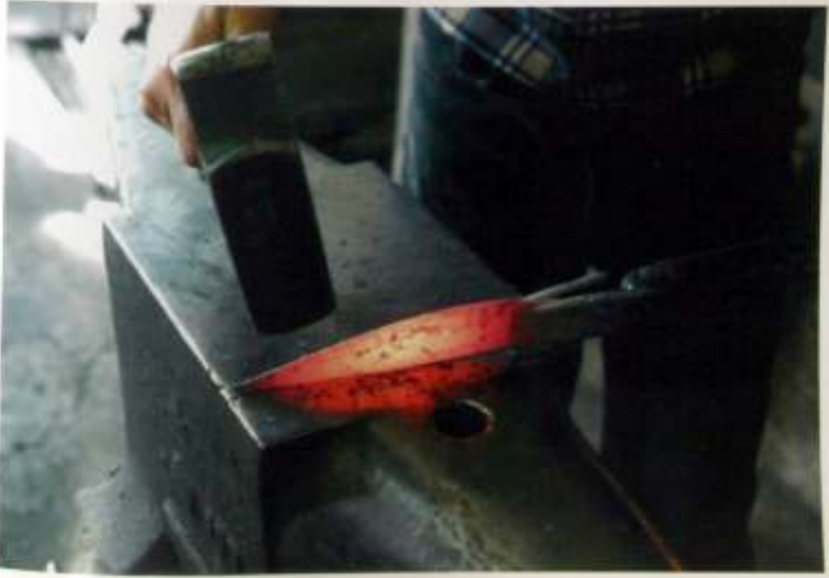
La lavorazione delle lame damascate è un capitolo a parte, qui l'abilità dell'artigiano tocca i suoi massimi. Il damasco è costituito da numerosi strati sovrapposti di acciaio e nichel. L'accoppiamento di questi materiali ed il procedimento utilizzato danno alle lame caratteristiche di resistenza e flessibilità uniche. Nell'immagine il "pacchetto" di acciaio e nichel pronto per la lavorazione. (gentile concessione Coltelliera Piero Fogarizzu - Pattada).
