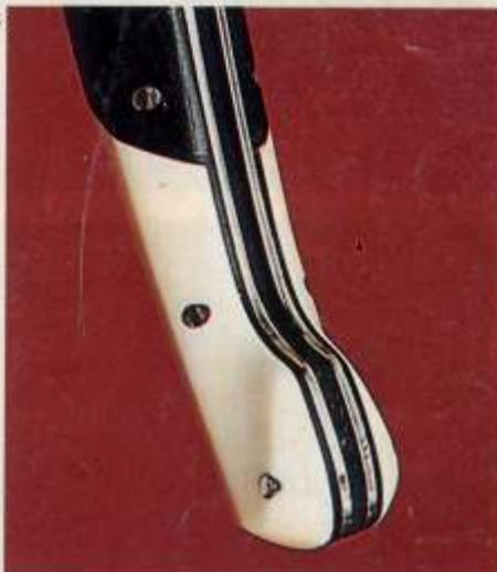
forte legame con la tradizione. La classica «resolza» (cioè quella che fuori dalla Sardegna viene chiamata, talvolta impropriamente, «Pattada») viene fabbricata in sette differenti misure, con lame di 7,5 - 9 - 10 - 11 - 12 - 15 - 17 centimetri, utilizzando per il manico corno di montone o di muflone, e qualche volta anche altri materiali particolari come ebano, avorio, radiche.
